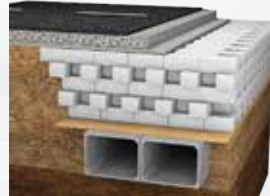
Gömülü Menfez İnşaatlarında Austrotherm geoBLOCK® Uygulaması
