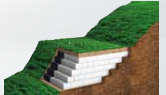
Şev Stabilitesi Uygulamalarında Austrotherm geoBLOCK® Uygulaması
