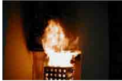
Resim1: Cephe yangın testi
